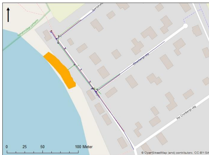
Figur 3-14 VA-ledningar nära planerad stenskning vid Brovägen i Nyhamnsläge. Avloppsledningar är färgade röda, färskvattenledningar är färgade blå, dagvattenledningar är färgade gröna och ledningar som inte är i bruk är färgade svarta. Information erhållen från Höganäs kommun 2020-06-11.
