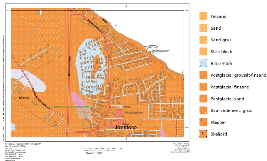
Figur 5-1 Dominerande jordart på strandområdet vid den planerade stenskingen i Jonstorp (SGU, u.å.-a).
